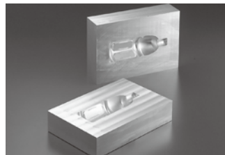
鋼とアルミ合金のWEDM加工速度比較
